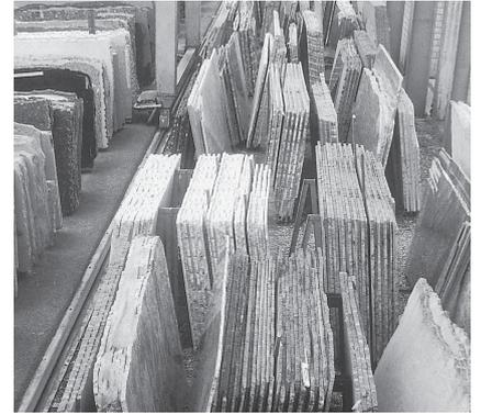
*Vom Rohblock zum Halbfabrikat (Unmassplatte, Rohlinge, Pflastersteine etc.).*
