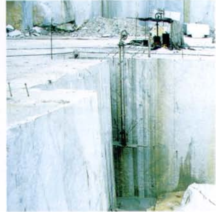
Abb. 11 Abbau mit Seilsägeverfahren in Marmorbruch
